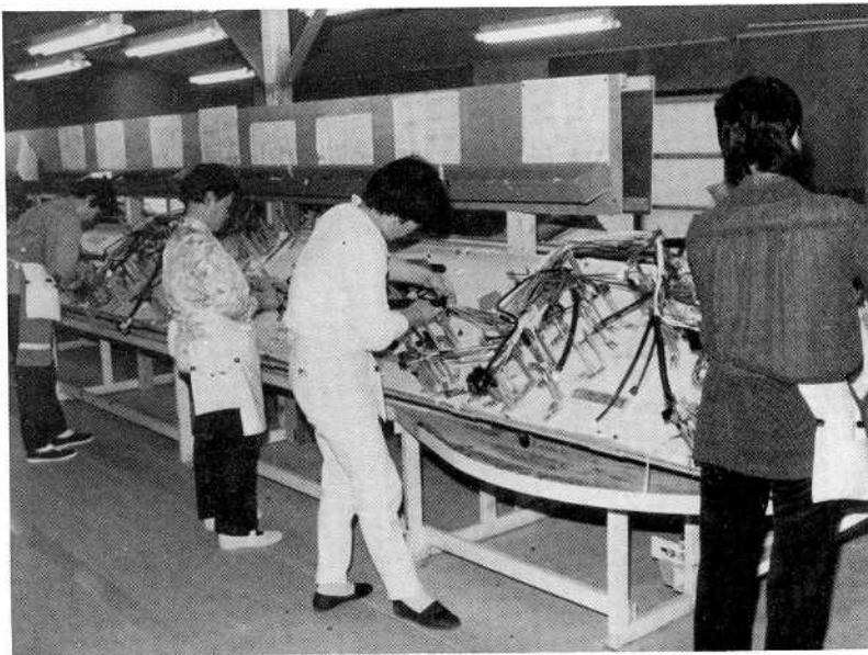
自動車用組電線を製造する岐阜部品株式会社仮工場内
