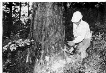
②受け口を作るために30~40°で斜め切りをする
