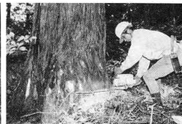
①伐倒方向を決め樹心に向けて水平に切り込む
