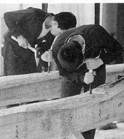
のみ穴1個のみ… (プレカット工場)
