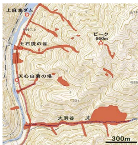
図24 土石流・土砂崩れの発生場所 国土地理院の地図・空中写真閲覧サービスを使用 赤色部が土砂崩壊発生場所
